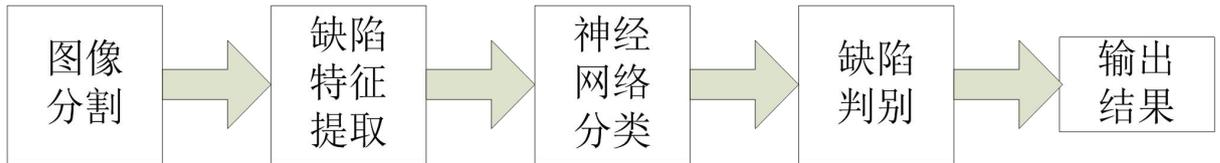
图 2 缺陷检测、分类的流程图
