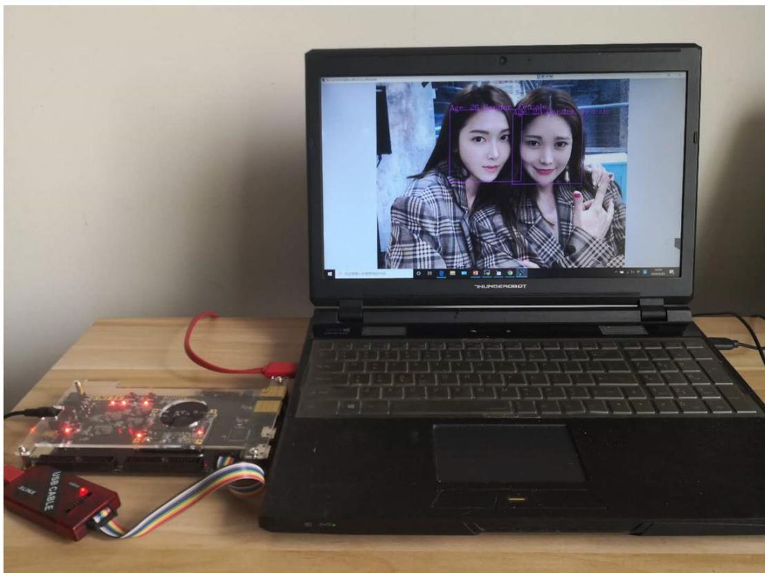
图 2 人脸检测与识别的 FPGA 平台系统
