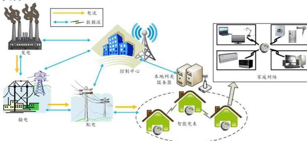
图1 智能电网的用电数据流通模型
